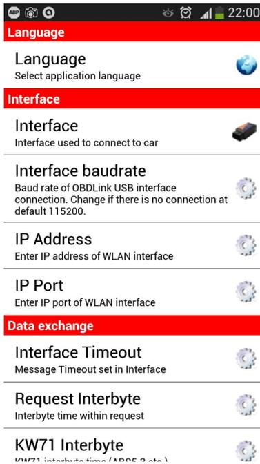
L'interface OBD utilisée est sélectionnée dans la liste "Interface". AlfaOBD vérifie le type de l'interface connectée lors de la connexion à un ECU de voiture. Si une mauvaise interface est sélectionnée dans les préférences, AlfaOBD peut corriger la sélection.
